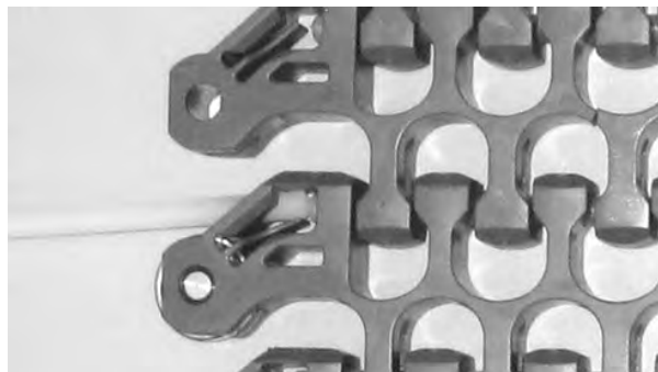
Figur 299: Trekk pinnen fra båndet
