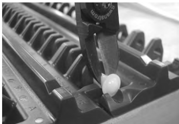
Figur 100: Kutt av pinnehode
