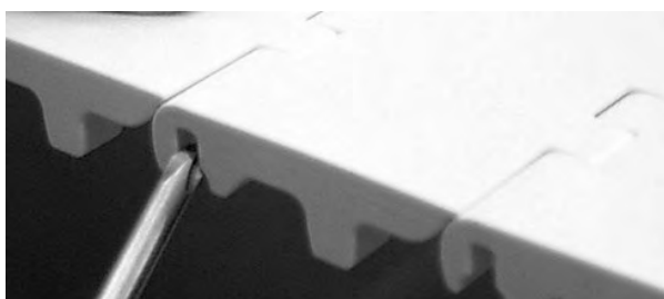
Figur 204: Skyv pinnen forbi låsemekanismen
