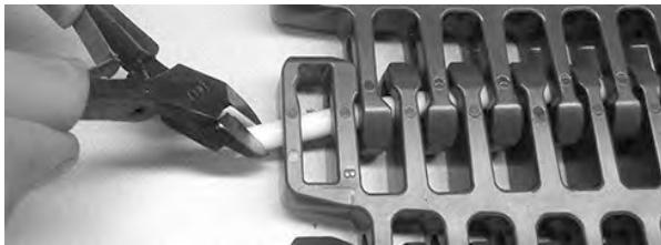
Figur 334: Trekk pinnen fra båndet
