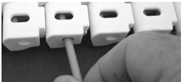
Figur 282: Sett inn pinne gjennom hengsler
