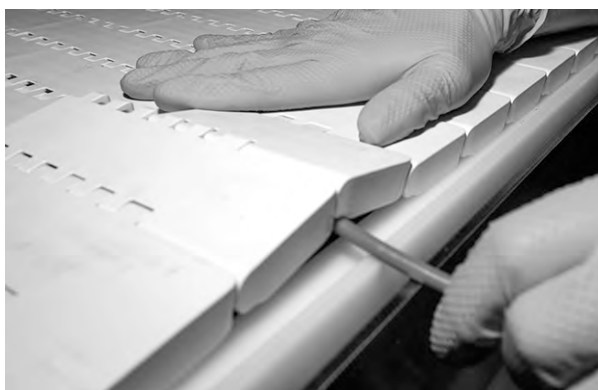
Figur 88: Bøy pinnen litt, og sett den inn gjennom hengslene
