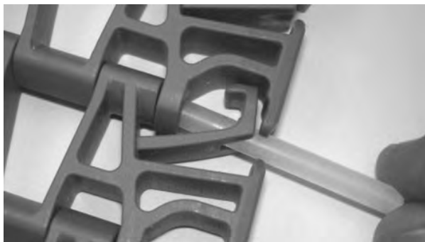
Figur 246: Sett inn pinne gjennom hengsler
