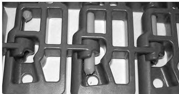
Figur 124: Sørg for at pinnen settes så langt inn som mulig
