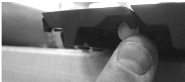
Figur 98: Skyv pinnen forbi låsemekanismen
