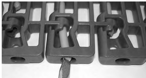
Figur 123: Skyv pinnen forbi låsemekanismen
