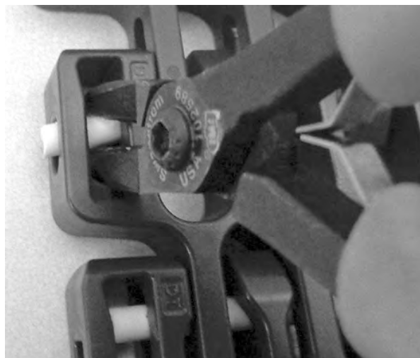
Figur 316: Skyv pinnen til siden og forbi hullet
