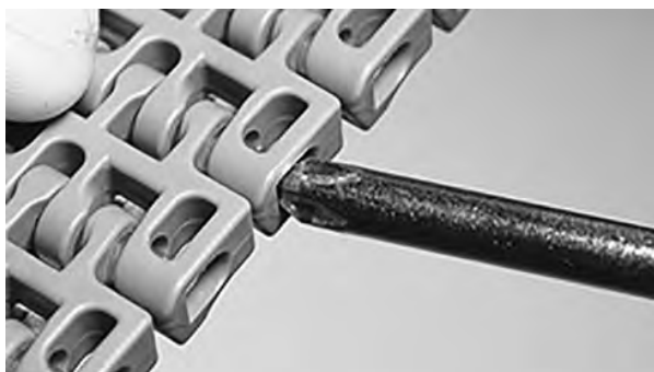
Figur 136: Skyv pinnen forbi låsemekanismen
