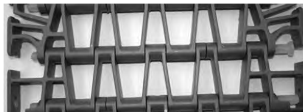
Figur 255: Sørg for at pinnen er forbi låsemekanismen
