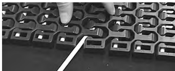
Figur 304: Sett inn pinne gjennom hengsler
