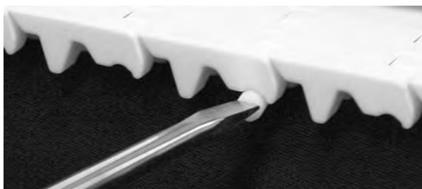
Figur 174: Skyv pinnen forbi låsemekanismen
