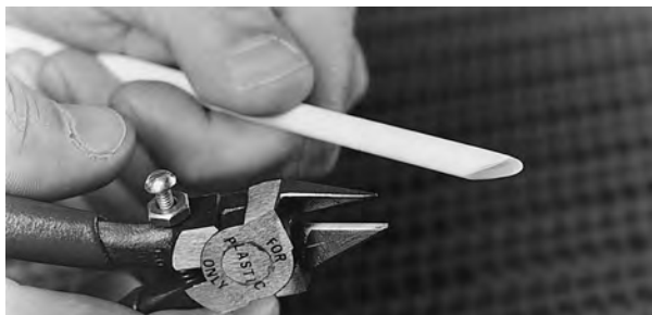
Figur 14: Kutt pinnen i en vinkel
