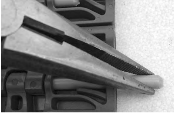
Figur 131: Trekk pinnen fra båndet
