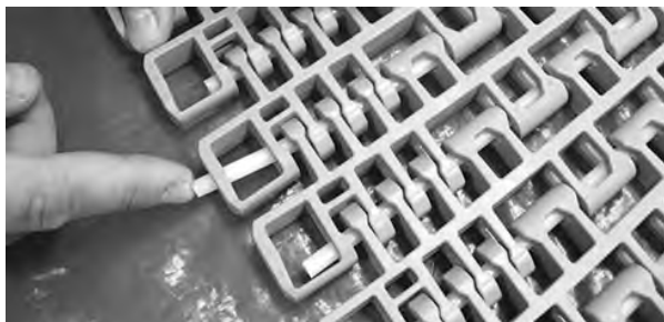
Figur 338: Skyv pinnen forbi låsemekanismen
