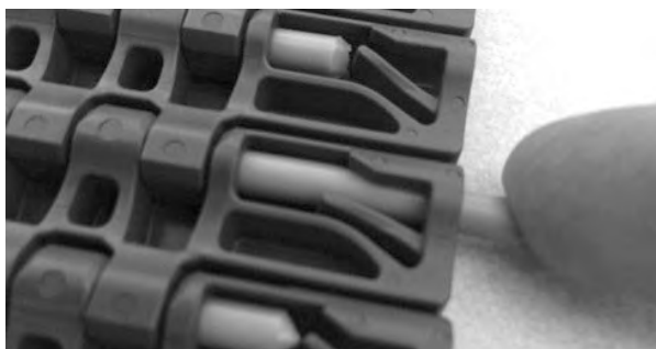
Figur 127: Skyv pinnen gjennom hengslene
