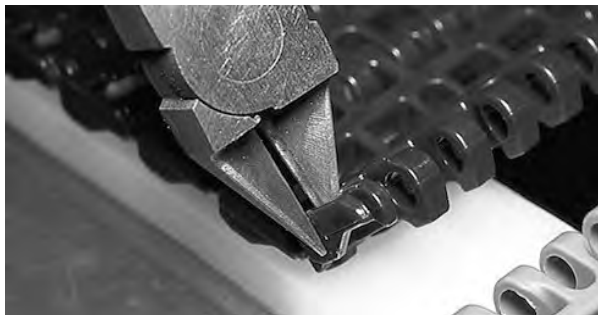
Figur 140: Kutt av halvparten av kanten
