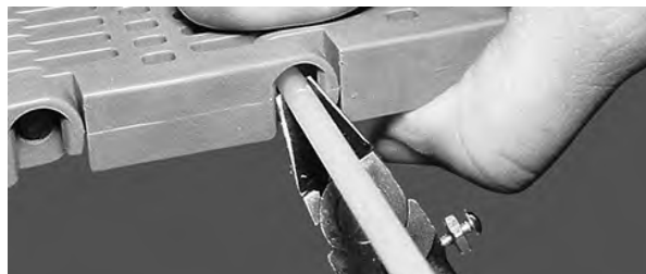
Figur 39: Kutt pinnen i fluks med båndkanten
