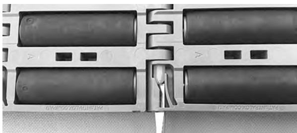
Figur 241: Skyv pinnen forbi låsemekanismen
