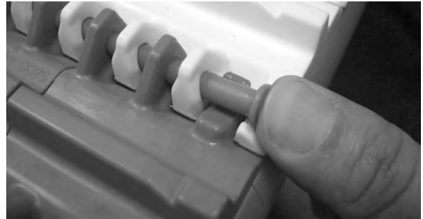
Figur 77: Skyv pinnen forbi låsemekanismen
