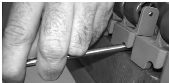
Figur 193: Sett inn stålsplinten i hengselen
