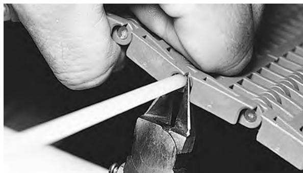
Figur 113: Kutt pinnen i fluks med båndkanten
