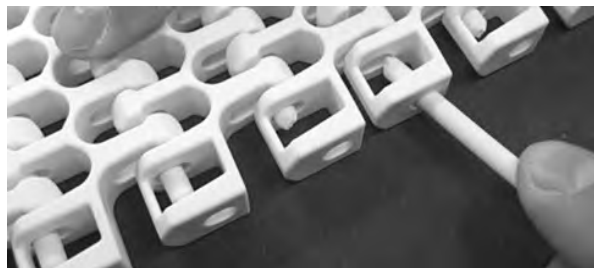
Figur 287: Sett inn pinne gjennom hengsler
