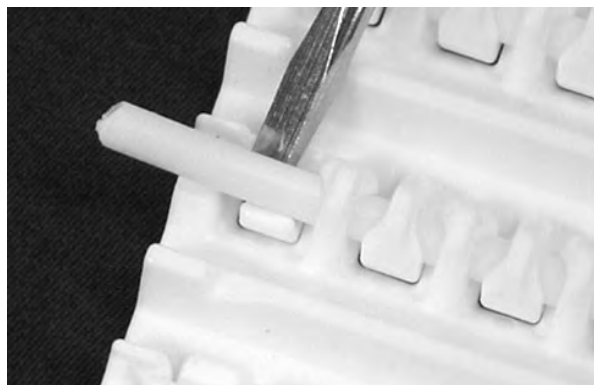
Figur 176: Løft pinnen over låsemekanismen
