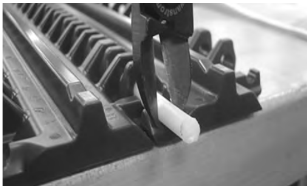
Figur 72: Trekk pinnen fra båndet
