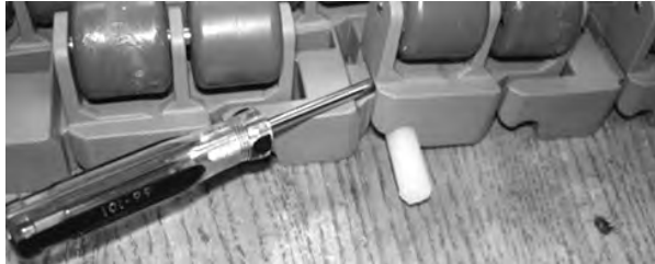
Figur 195: Trekk pinnen fra båndet
