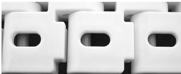
Figur 284: Sørg for at pinnen er forbi låsemekanismen
