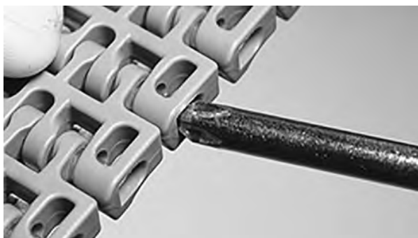
Figur 145: Skyv pinnen forbi låsemekanismen
