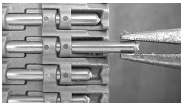
Figur 57: Trekk pinnen fra båndet
