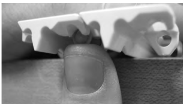
Figur 180: Skyv pinnen forbi låsemekanismen
