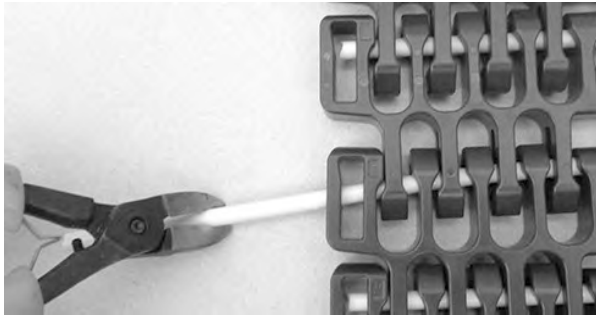
Figur 317: Trekk pinnen fra båndet
