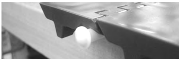
Figur 96: Sett inn pinne gjennom hengsler
