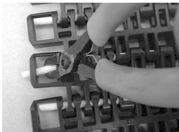
Figur 357: Skyv pinnen forbi låsemekanismen
