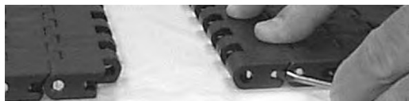
Figur 160: Bruk skrutrekker til å lukke Slidelox
