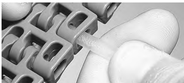
Figur 135: Sett inn pinne gjennom hengsler
