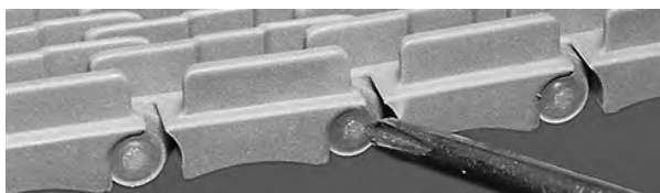
Figur 23: Kontroller at pinnehodet er forbi Snap-Lock
