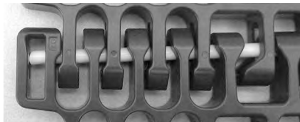
Figur 315: Sørg for at pinnen er forbi låsemekanismen
