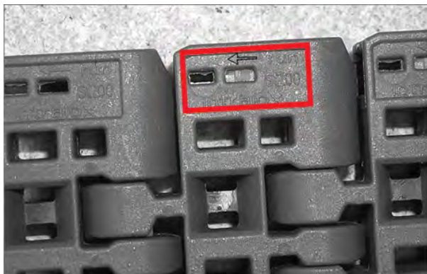
Figur 154: Kjøreretning for bånd
