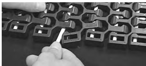
Figur 306: Sett inn pinne gjennom hengsler
