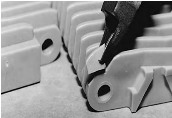
Figur 47: Kutt den ytterste ribben
