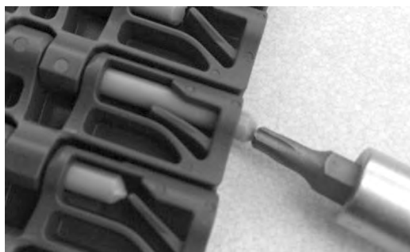
Figur 128: Skyv pinnen forbi låsemekanismen
