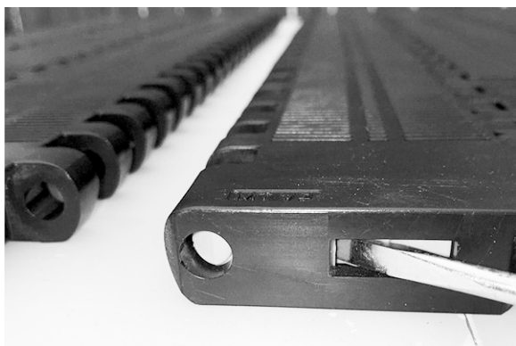
Figur 209: Bruk skrutrekker til å lukke Slidelox
