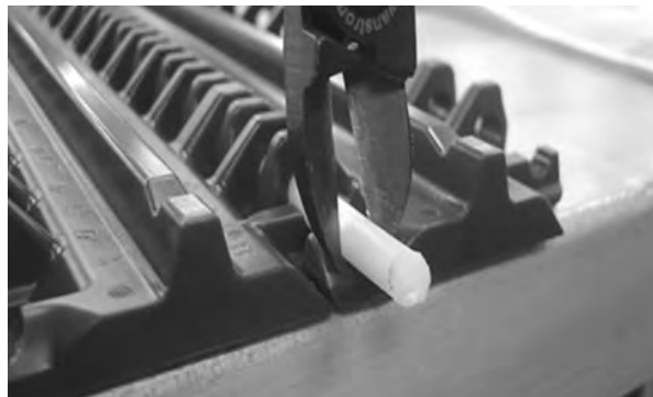
Figur 101: Trekk pinnen fra båndet
