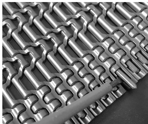
Figur 61: Løft pinnen over låsemekanismen
