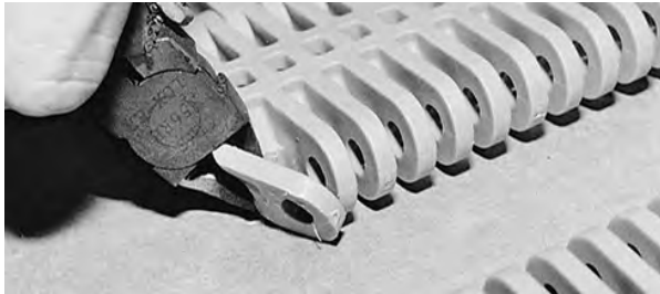
Figur 46: Kutt det ytterste leddet
