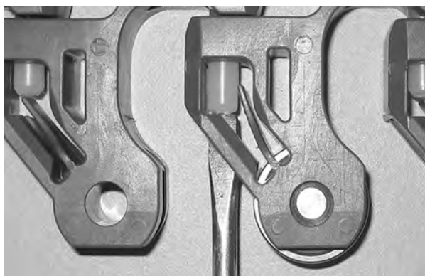
Figur 278: Skyv pinnen forbi låsemekanismen
