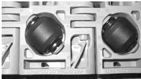
Figur 226: Sørg for at pinnen er forbi låsemekanismen
