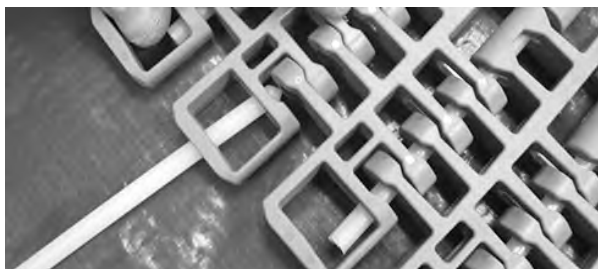
Figur 337: Sett inn pinne gjennom hengsler
