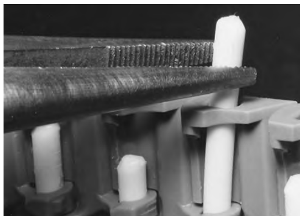
Figur 149: Trekk pinnen fra båndet
