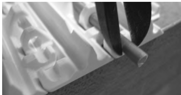
Figur 183: Trekk pinnen fra båndet
