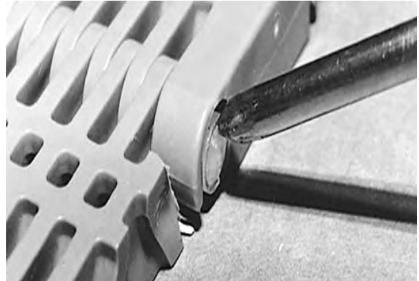
Figur 48: Skyv pinnehodet forbi låsemekanismen
