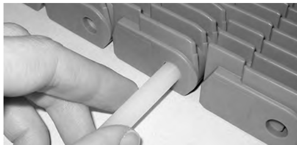
Figur 218: Trekk pinnen fra båndet
