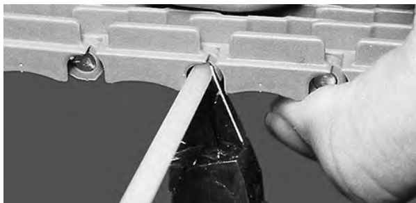
Figur 24: Kutt pinnen i flukt med båndkanten
