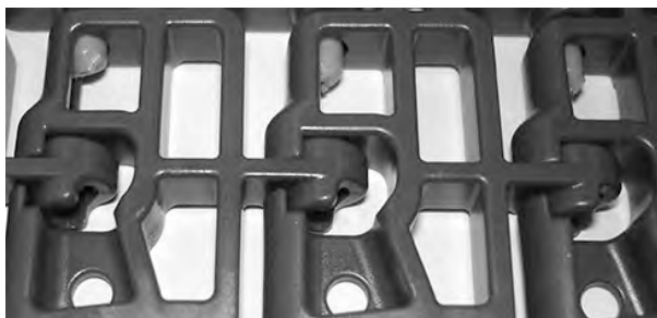
Figur 116: Pinner beveges inne i den jevne kanten
