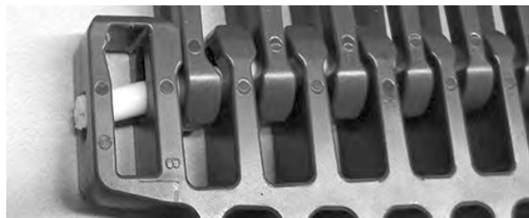
Figur 331: Sett inn pinne gjennom hengsler
