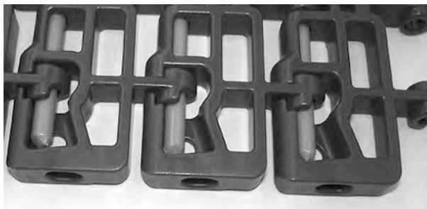
Figur 117: Pinnen utvides inn i den jevne kanten
