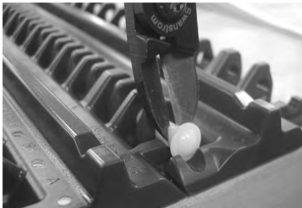
Figur 71: Kutt av pinnehode
