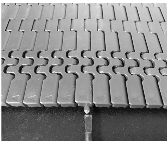
Figur 59: Skyv pinnen forbi låsemekanismen
