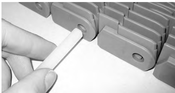
Figur 215: Sett inn pinne gjennom hengsler
