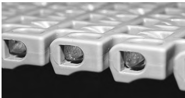
Figur 146: Sørg for at pinnen er forbi låsemekanismen
