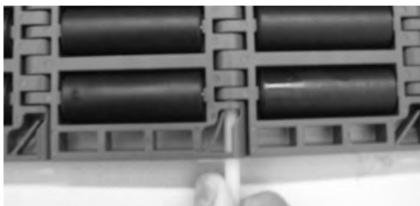
Figur 236: Sett inn pinne gjennom hengsler
