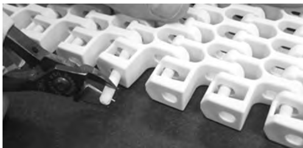
Figur 291: Trekk pinnen fra båndet
