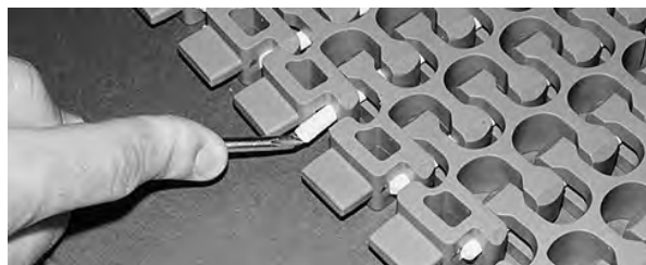
Figur 271: Sørg for at pinnen er forbi låsemekanismen
