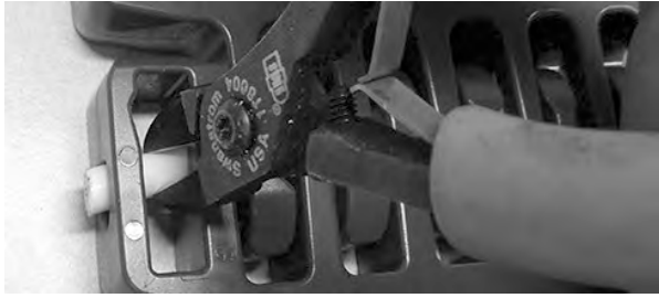
Figur 333: Skyv pinnen til siden og forbi det lukkede hullet
