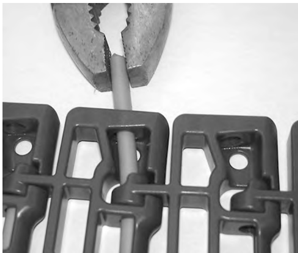
Figur 126: Trekk pinnen fra båndet
